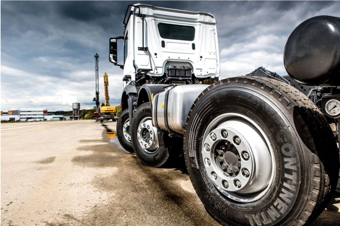
Bild 1: © Paul Nutzfahrzeuge GmbH / Zugmaschine – Hinterachse mit EHLA® elektrohydraulischem Hilfslenksystem
