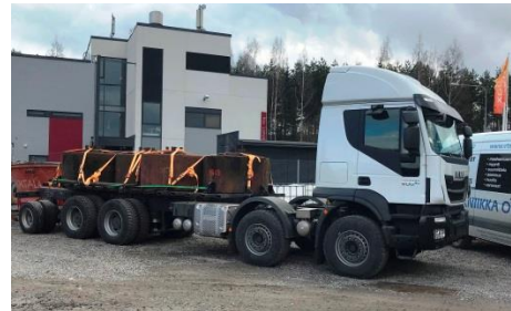
Bild 2 und 3: EHLA® ECO STANDARD für unterschiedliche Fahrzeugtypen (links/Bild 2: Volvo mit Vorlaufachse, rechts/Bild 3: IVECO mit Nachlaufachse)
