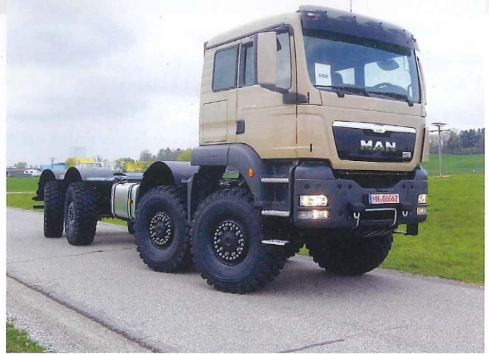
Jede Achse ist einzelbereift, gelenkt und angetrieben.
