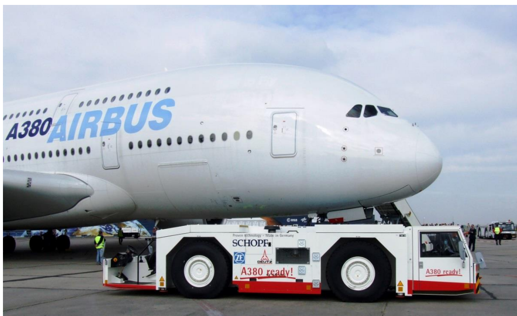
Bild 2 Flugzeugschlepper (Pushback) mit elektrohydraulischem Lenksystem von MOBIL ELEKTRONIK
