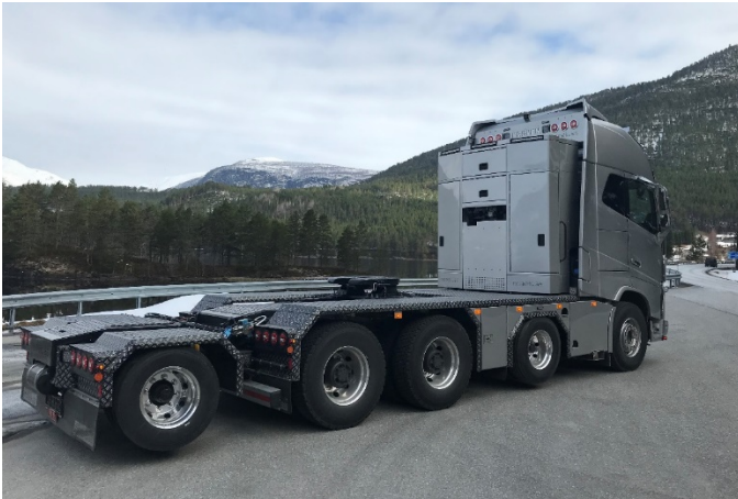
Abbildung 2: © Vangs 4-Achs Zugmaschine mit montierter Andockachse
