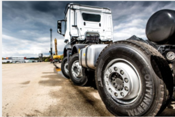
Hinterachse mit elektrohydraulischem Hilfslenksystem.
