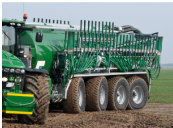
Garant Quadro mit elektronisch-hydraulischem Hilfslenksystem von MOBIL ELEKTRONIK
